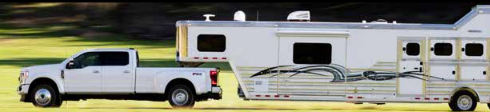
$$\text{Poids à vide en ordre de marche} + \text{Poids de la charge} + \text{Poids des passagers} = \text{Poids total en charge (PTC)}$$
